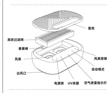
1. 电源键:接通电源后净化器开机进入自动模式,指示灯亮起绿色 轻触电源键净化器停止工作。
